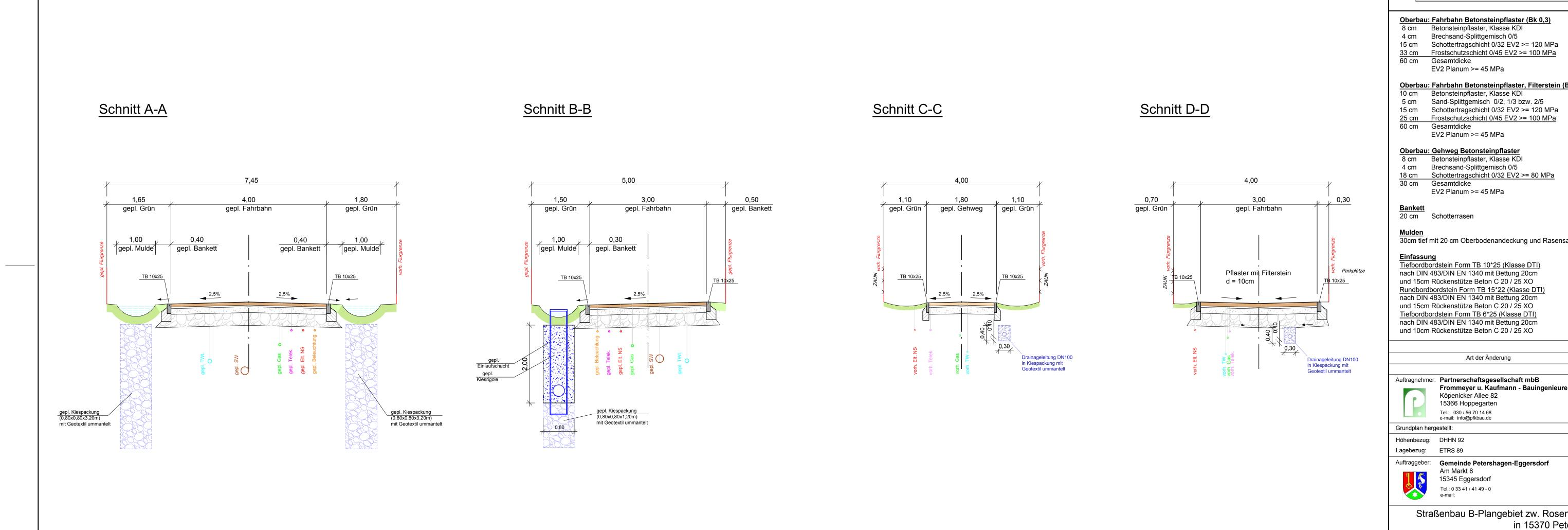
Oberbau: Fahrbahn Betonsteinpflaster, Filterstein (Bk 0,3) 30cm tief mit 20 cm Oberbodenandeckung und Rasensaat
